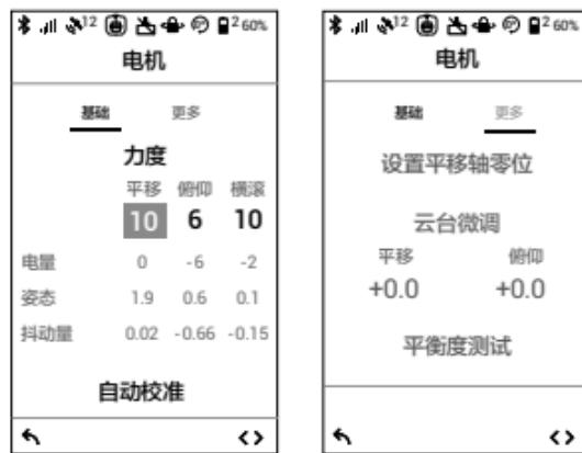
基础：平移轴、俯仰轴、横滚轴的力度、强度、滤波、超前控制值设置；显示云台电量、姿态与抖动量；进行云台自动校准。
