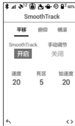
平移轴、俯仰轴、横滚轴的 SmoothTrack 可分别开启或关闭。平移轴、俯仰轴可开启手动调节。
