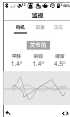
**电机：**显示平移轴、俯仰轴、横滚轴电量、关节角、温度。
